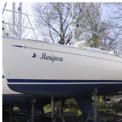
Na het opbrengen van de laatste laag zelfslijpende antifouling
