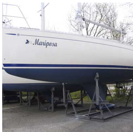
Na het opbrengen van de koperhoudende harde antifouling
