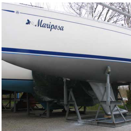
Na het opbrengen van de Primocon
