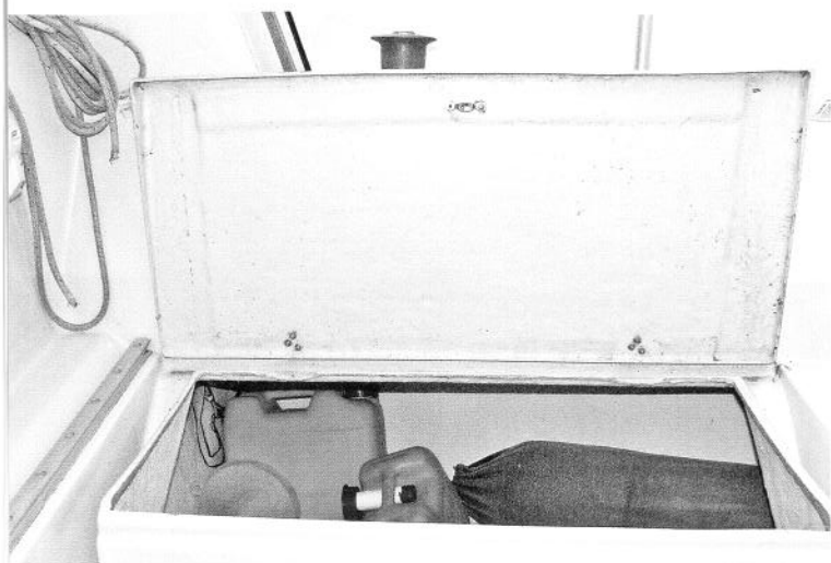
In zwei großen Backskisten steht viel Stauraum zur Verfügung, serienmäßig sind die Deckel leider nicht mit Dichtungen versehen.
