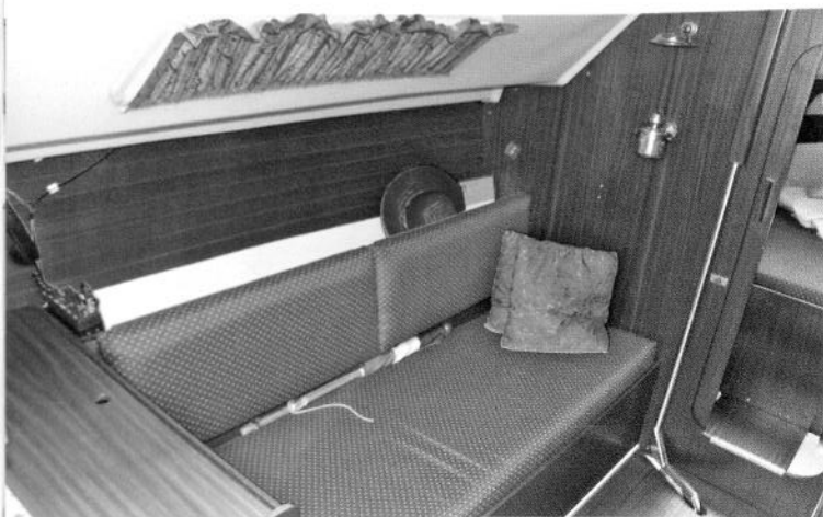
Auf geschlossene Schapps im Salon wurde aus Kostengründen vollständig verzichtet, Taschen und Bettzeug können hinter den Rückenlehnen gestaut werden.
